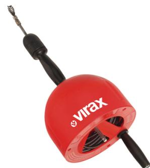
Déboucheur manuel pour canalisations Ø25-75mm. Livré avec câble à âme acier Ø7mm/7,5m, flexible et résistant, pour Ø25-50mm. Vrille articulée pour passage facilité dans les coudes. Maniable (seulement 2,7kg). Utilisable avec perceuse (non fournie).
