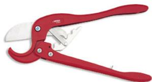
Coupe-tube utilisé pour la coupe rapide des tubes en PVC, PP, PE, PER, ABS, PEHD, également pour tubes multicouches. Crémaillère de démultiplication de l'effort. Loquet de verrouillage.
