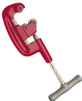
Épaisseur maxi : 5 mm. Permet de couper rapidement les tubes acier (gaz-API-etc...) parfaitement d'équerre et sans copeaux. Aussi pour tubes inox (épaisseur > 2 mm) avec les molettes 210123 et la fonte grise avec les molettes 210122.
