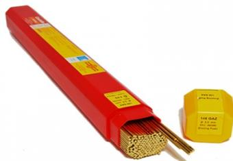
Baguette marquée portant le repère d'enregistrement ATG N° 1567 pour les installations de gaz combustibles (Gaz de France). Soudobrasage des tuyauteries en cuivre et en acier. Brasage capillaire fort des tuyauteries en acier. A utiliser obligatoirement avec le décapant 146 M pour les installations de gaz combustibles.
