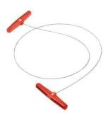
Fil fin dont le trait de scie épais permet une mise en ?uvre rapide. Poignées solides. 90 cm. Convient pour le PVC, PVC-C, PP et PE. Mode d'emploi : Disposez le fil autour du tuyau et tirez dessus en un mouvement de va et vient de manière à scier le tuyau. Le fil va s'enrouler.
