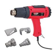
Décapeur thermique à 2 positions. Réglage de la température par molette. 6 plages de 50° à 650°C. Livré avec 4 buses différentes. Utilisation : pour détacher peintures et laques, soudage et brasage avec différents matériaux.
