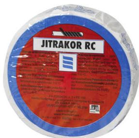
Bande anticorrosion à base de petrolatum et recouverte d'un film PVC thermorétractable pour la protection des conduites, des raccords et d'autres structures métalliques souterraines encastrées, disposées sous une chape ou enterrées. Utilisable lorsque la température d'exploitation se situe entre -30 °C et 110 °C.
