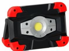
Livré avec un câble micro USB. Temps de charge : 4-5 heures. Temps de fonctionnement : 3h à 100% / 6h à 50%. Batterie - PBC10 : 3,7V - 4,4A Li-Ion / PBC20 : 7.4V - 4.4A Li-Ion. Indicateur de charge. Interrupteur marche-arrêt. 2 sorties USB : 1 micro USB - 1 USB. Etrier aimanté. Crochet de suspension. IP65 - IK08 - 6400 K.
