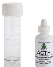
Kit de mesure pour calculer la dureté de votre eau, indispensable pour le réglage de votre adoucisseur. Flacon gradué et gouttes, pratique dosage mono composant 1 goutte = 1 degré TH. Réaction colorée rose ou bleu. Possibilité de réaliser 50 mesures.
