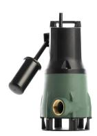
Pompes submersible étudiées pour le relevage d?eaux usées provenant de fosses biologiques capables d?absorber des corps solides en suspension d?un diamètre maximum de 25mm. Interrupteur automatique à flotteur sur modèles AUT. FÉKA 600 AUT livrés avec 5 mètres de câble d?alimentation type HO5 RN.F. Hauteur minimum d'aspiration: FEKA 300: 95 mm - FEKA 600: 190 mm. Plage d'utilisation: de 1 à 15m3/h avec hauteur manométrique jusqu'à 10,2 mCE. Normes: CEI 2 - 3 et CEI 61 - 69 (EN60 335-2-41).
