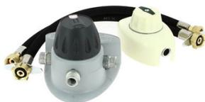
Comprend 1 inverseur automatique 2175 C équipé d'un indicateur réserve-service, 1détenteur déclencheur S CLASSE 2, 2 lyres élastomère P14 (45 cm) validité 5 ans, 3 raccords à braser P45-41 écrou M20 x 1,5 pour tube cuivre diamètre extérieur 12 mm.
