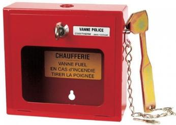
Coffret avec accessoires en tôle prélaquée rouge sous verre dormant (dimension : 155x165x60mm) avec une serrure H520, pour abriter un système déporté d'arrêt d'urgence (poignée avec 10m de câble)
