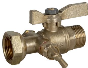
Robinet de compteur droit à purge laiton 4 MS sans plomb 3/4"-3/4", ACS à boisseau sphérique commande par manette 2/3 1/3 1/4 tour pour les réseaux d'adduction et de distribution d'eau.
