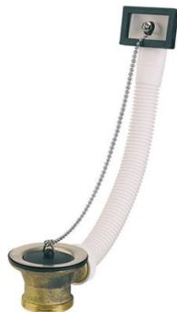
Bonde à bouchon-chaînette pour évier 1 cuve de diamètre 50 mm avec trop plein. Cuvette diamètre 70 mm, bouchon noir diamètre 45 mm, serrage de 0 à 10 mm. Corps en laiton, chaînette 300 mm recoupable.
