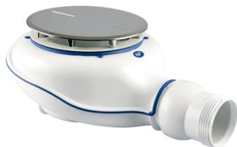
Très haut débit 43L/min. Rotule orientable à visser ou à coller. Encombrement : 80 mm et garde d'eau : 50 mm. Raccordement à la canalisation : à visser G1"1/2. Corps bi-matière : polypropylène + élastomère et capot métal en zamac chromé ou PVC selon modèle.
