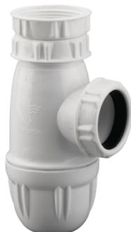
Siphon pour évier. Hauteur réglable de 62 à 97 mm. Encombrement réglable de 149 à 184 mm. Sortie diamètre 40 mm et entrée 1"1/2. Débit 54 l/mn. Certifié NF.
