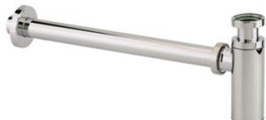
Siphon chromé pour vasque, équipé d'une sortie murale et d'une rosace. Hauteur réglable de 50 à 120 mm. Débit 42 l/mn. Sortie diamètre 32 mm. ABS chromé.
