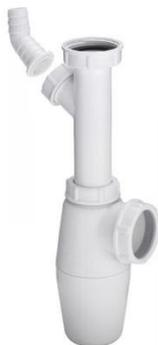
Réglable en hauteur, avec prise machine à laver. Plastique. Sans : tube d'évacuation, rosace. Tasse Ø 50 mm, raccordement de flexible pour eaux usées. G 1"1/2.
