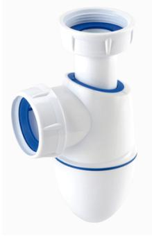
Siphon bi-matière réglable en hauteur avec joints intégrés, culot dévissable. Raccordement d'entrée : G 1 1/4, hauteur réglable : 133 ? 192 mm, garde d'eau : 50 mm.
