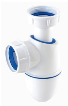
Siphon bi-matière réglable en hauteur avec joints intégrés, culot dévissable. Raccordement d'entrée : G 1/4, hauteur réglable : 133 ? 192 mm, garde d'eau : 50 mm.
