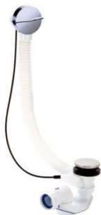
Siphon 100% bi-injecté anti encrassement. Garde d'eau : 50 mm / Trop plein pré-monté ajustable en hauteur. Encombrement sous baignoire réduit à 94 mm. Rotule orientable à 360° et inclinable à +/- 5°. Matière vidage : PP & TPE. Matière volant et clapet : ABS ou Laiton. Clapet recouvrant. Diamètre clapet : 70 mm.
