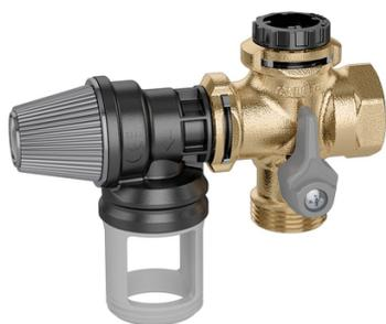
Groupe NF antipollution pour chauffe-eau (max 10 kW) vertical ou horizontal. Avec clapet anti-retour, vanne d'isolement et une soupape en technopolymère avec siège ultra résistant tarée à 7 bar. Adapté pour les eaux calcaires et agressives.
