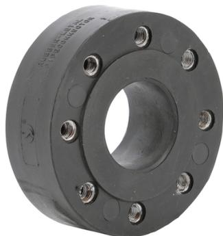
Manchon antibruit série 1509, corps EPDM monobloc, inserts en acier taraudés PN10 pour absorption des vibrations et bruits, réseaux d'adduction et de distribution d'eau
