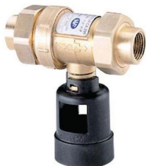
Disconnecteur pour la protection d'installations de chauffage domestique, d'équipement de laboratoire etc? Comprend deux clapets de non retour séparés par une chambre communiquant avec l'atmosphère.
