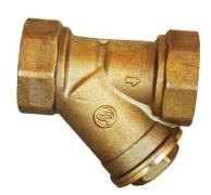
Filtre à tamis en Y laiton 4MS pour les réseaux d?adduction et de distribution d?eau. Filtration de 850 avec tamis en inox 304 démontable. L?étanchéité est assurée par un joint torique EPDM. Compatible avec les réseaux d?eau potable grâce à l?attestation de conformité sanitaire (ACS).
