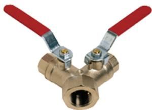
Vanne à sphère laiton 3 voies en Y à passage réduit pour le sectionnement de réseaux d'eau, de chauffage, arrosage, irrigation, climatisation et air comprimé. L'étanchéité est assurée par un presse étoupe.
