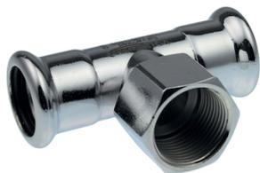
Té taraudé en équerre en acier au carbone avec deux extrémités à sertir et une extrémité taraudée. Butée : bord d'arrêt pour extrémité de tuyau. Fourni avec toutes les homologations applicables. Fonction fuite avant sertissage. Identification claire lors du montage du matériau et de la dimension.
