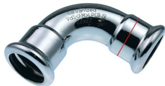
Courbe à 90° en acier au carbone avec 2 extrémités extrémités femelles à sertir. Butée : bord d'arrêt pour extrémité de tuyau. Fourni avec toutes les homologations applicables. Fonction fuite avant sertissage. Identification claire lors du montage du matériau et de la dimension.
