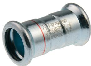
Manchon en acier au carbone avec 2 extrémités à sertir. Butée : bord d'arrêt pour extrémité de tuyau. Fourni avec toutes les homologations applicables. Fonction fuite avant sertissage. Identification claire lors du montage du matériau et de la dimension.
