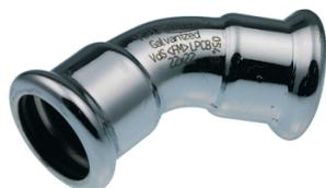
Courbe à 45° en acier au carbone avec 2 extrémités à sertir. Butée : bord d'arrêt pour extrémité de tuyau. Fourni avec toutes les homologations applicables. Fonction fuite avant sertissage. Identification claire lors du montage du matériau et de la dimension.
