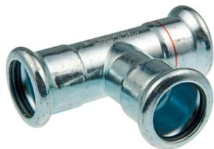
Té égal en acier au carbone avec 3 extrémités à sertir. Butée : bord d'arrêt pour extrémité de tuyau. Fourni avec toutes les homologations applicables. Fonction fuite avant sertissage. Identification claire lors du montage du matériau et de la dimension.
