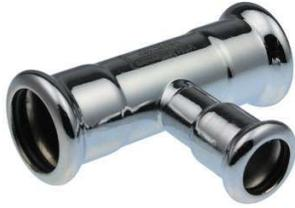
Té réduit en équerre en acier au carbone avec 3 extrémités à sertir. Butée : bord d'arrêt pour extrémité de tuyau. Fourni avec toutes les homologations applicables. Fonction fuite avant sertissage. Identification claire lors du montage du matériau et de la dimension.
