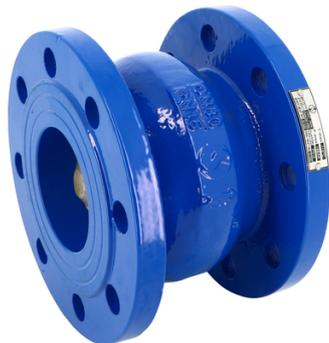
Clapet de non-retour à simple guidage à ogive pour les réseaux de chauffage, réseaux d'adduction, de distribution et d'évacuation d'eau. Le corps est en fonte EN GJL-250 revêtu d'une peinture époxy anticorrosion, l'ogive est en inox et l'étanchéité est assurée par un joint EPDM. Montage toutes positions grâce au ressort sur le clapet.
