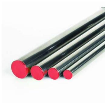
Tube de précision à paroi mince fabriqué conformément à la norme EN 10305-3 à partir d'un type spécial d'acier à très faible teneur en carbone. Le produit obtenu est très facile à cintrer. Les tubes sont également testés pour les fuites conformément à la norme ISO 10893-2:2011, de sorte que tous les tubes sont garantis sans fuite.
