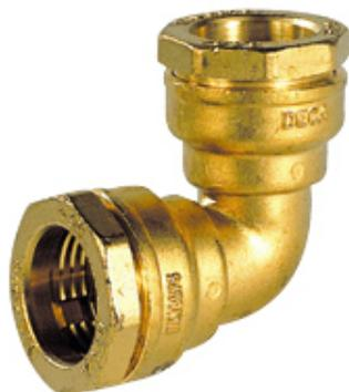
Dimensions : DN20 à DN90 Raccordement : Femelle, Femelle BSP et sur tube polyéthylène Température Mini : +4°C Température Maxi : +40°C Pression Maxi : 16 Bars jusqu'au DN63 (10 bars au-delà) Caractéristiques : Raccords laiton pour tube Polyéthylène Joint torique NBR Montage sur tube sans démontage du raccord
