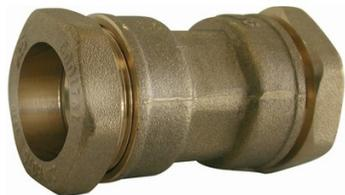
DN20 à DN90. Raccordement : Femelle, Femelle BSP et sur tube polyéthylène. Température Mini : +4°C. Température Maxi : +40°C. Pression Maxi : 16 Bars jusqu'au DN63 (10 bars au-delà). Raccords laiton pour tube Polyéthylène. Joint torique NBR. Montage sur tube sans démontage du raccord.
