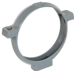
Le collier à bride en PVC permet de maintenir les canalisations en PVC, tout en permettant leur dilatation. La bride articulée à l'une des extrémités vient se refermer sur le tube de descente et se bloque sur le corps du collier grâce à une vis sécurisée.
