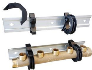
Compatible avec collecteurs 20x27 et 26x34 (Ø 22 à 34 mm). Montage facile et rapide par clipsage des colliers. Vis fournies pour finaliser l'installation. Adaptable à toute longueur de collecteurs (2 à 8 piquages) en coulissant les colliers. Possibilité de positionner indépendamment les collecteurs. Colliers en plastiques isophoniques et diélectriques.
