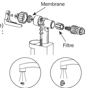
Visser à la main l'écrou du robinet jusqu'au contact de la céramique. Si nécessaire visser d'un quart de tour supplémentaire (maxi) à l'aide de la clé spécifique.
